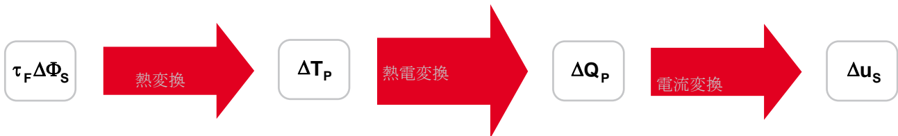
図1: 焦電型赤外線センサーの変換ステップ
