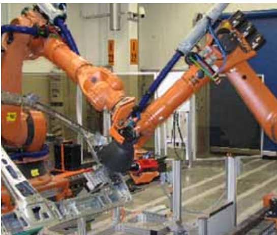
Abb. 4: Automatisierte Thermografie-Prüfanlage von InfraTec zur zerstörungsfreien Prüfung von Karosserieteilen für die Automobilindustrie
