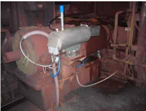
Abb. 2: Automatisiertes Thermografie-Messsystem INDU-SCAN zur Prozesskontrolle – Kontinuierliche Temperaturüberwachung bei der Blechherstellung, anlagennahe Installation der Thermografiekamera im Schutzgehäuse mit Wasserkühlung und Freiblaseeinrichtung
