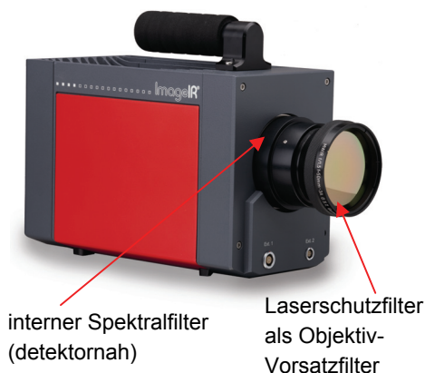
Abb. 1 High-End-Kameraserie ImageIR® mit motorisiertem Filterrad (4 Positionen)
