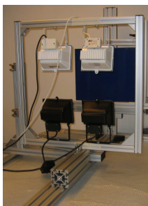
Abb. 1: Laboraufbau zur Aktivthermografie
