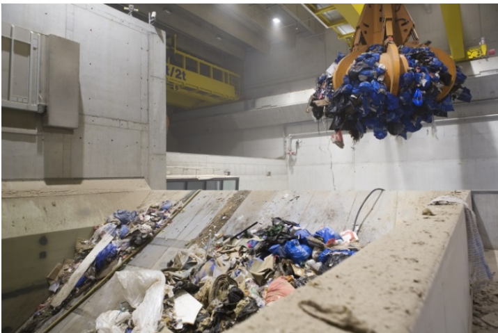
Abb. 4: An einzelnen Tagen erreichen bis zu 700 Tonnen Müll die EZF. Selbst die Rückstände nach der Verbrennung enthalten zahlreiche Rohstoffe, die erneut genutzt werden können. Auf diese Weise gewinnt das Kraftwerk jährlich rund 50 Kilogramm Quecksilber, 1,5 Tonnen Blei, 60 Tonnen Zink und eine Tonne Cadmium zurück.
