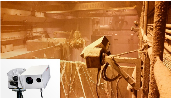
Abb. 2: Die Kombination aus Schwenk-/Neigeköpfen, Wärmebildkamera und visueller Kamera bietet einen hervorragenden Überblick über das Material, das sich in den verschiedenen Stapelkompartimenten befindet.
