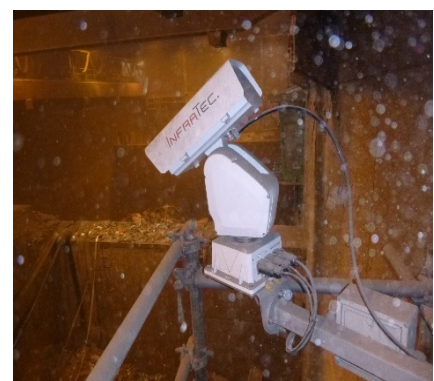
Abb. 3: TWIN-System integriert in einem Schwenk-/Neigekopf im Müllbunker
