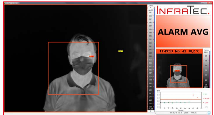
Sollte der vorher festgelegte Temperaturschwelle überschritten werden, erfolgt eine Alarmierung über die Software (hier: simulierter Testalarm)
