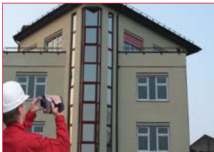
Erstellen von Thermografieaufnahmen
