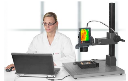
Lock-In-Thermografie-Paket mit VarioCAM® HDx und Software IRBIS® 3 active
