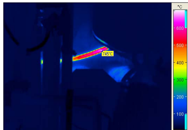
Abb. 3: Thermogramm des Walzgutes zur anschließenden Analyse in einer Spezialsoftware
